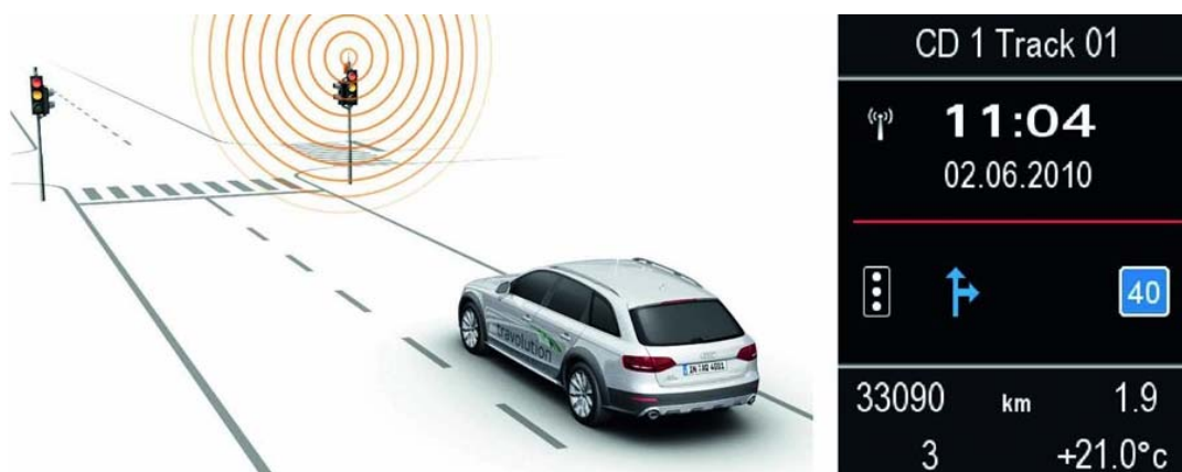
Avtomobilski sistem izračuna najprimernejšo hitrost za lovljenje zelenega vala
