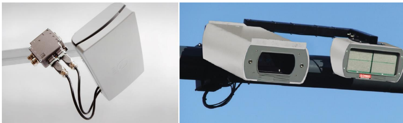
Mikrovalovna antena (levo) ter kamera za avtomatsko razpoznavo registrskih tablic z osvetljevalcem (desno)
